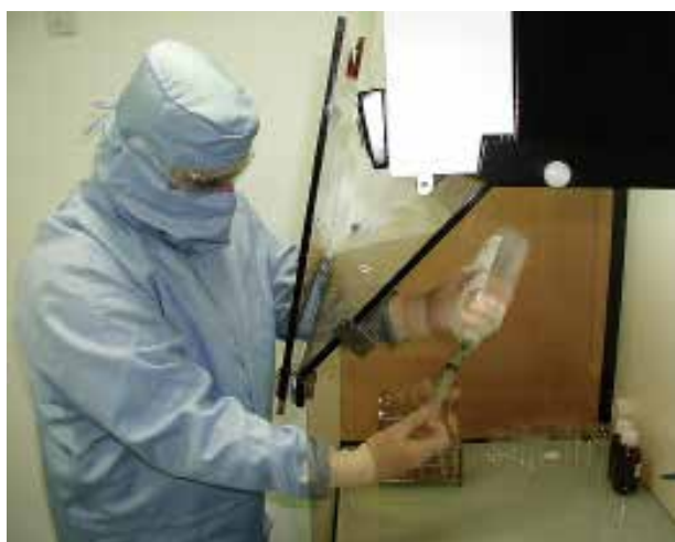
Figura 3. Técnico con la vestimenta adecuada para trabajar en zonas limpias bajo campana de flujo laminar.
