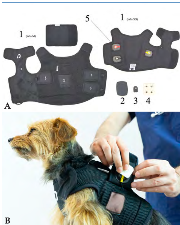
Figura 1. (A) Componentes del equipo de monitorización multiparamétrica inalámbrica empleada en el estudio: arnés y extensor (1), receptor de bolsillo (2), sensor de temperatura (3), electrodos adhesivos (4), electrodos de botón (5). (B) Dispositivo colocado en un perro. Nótese la zona depilada justo en la ventana del electrodo escamoteable y el electrodo adhesivo colocado listo para acoplarse.
